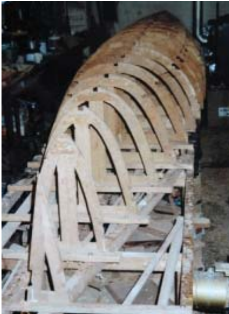
Skabelonerne, som bruges fra gang til gang, lines op og fastskrues på beddingen. I skabelonerne er der skåret ud til køl, essing og langrem.
