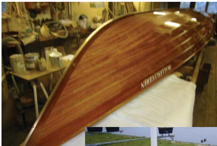
Båden vendes en sidste gang, og den sidste slibning og lakering udvendig afslutter arbejdet.
